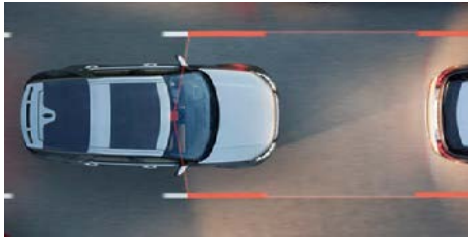
Функція попередження про відхилення від траєкторії руху
