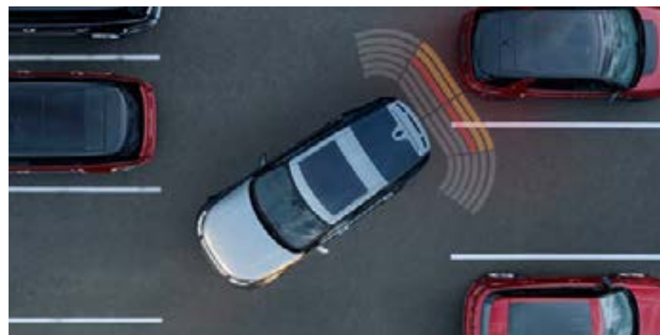
Допоміжна система паркування із задніми датчиками
