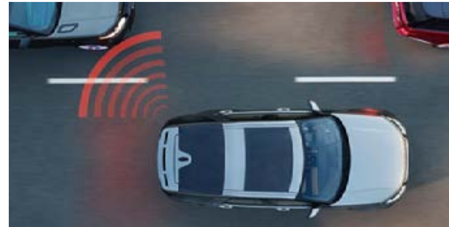
Система моніторингу сліпих зон
