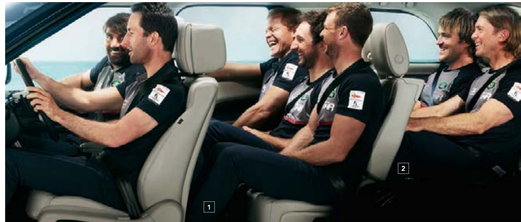
1 Простір для ніг пасажирів другого ряду 954 мм 2 Простір для ніг пасажирів третього ряду 851 мм
