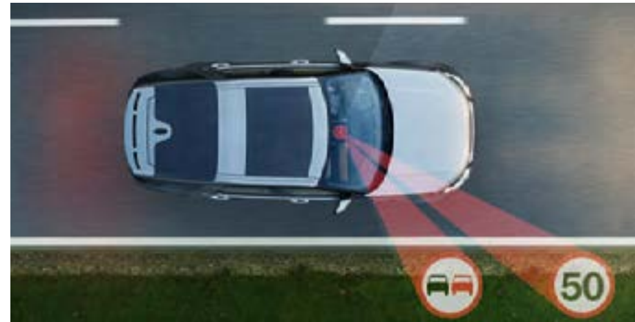
Система розпізнавання дорожніх знаків Traffic Sign Recognition з адаптивним обмежувачем швидкості
